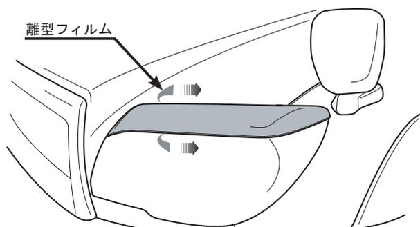
1. ヘッドライトガーニッシュの取り付け状態を確認し、残っているテープの離形フィルムをゆっくりはがしてください。
