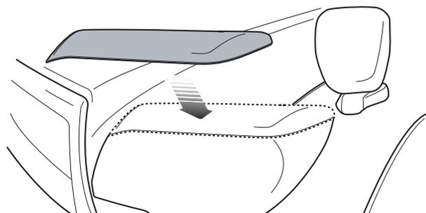
1. [1] で確認したテープ被接触面（ヘッドライト側）をきれいに清掃及び脱脂し、ヘッドライトガーニッシュを取り付けてください。
