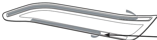
1. ヘッドライトガーニッシュを取り付ける前に、テープの離形フィルム末端を少しだけはがしてください。
