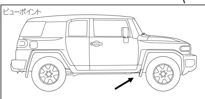
・フロントタイヤ後部の車底部（ボディマウント後部）にあるサービスホール2ヶ所を利用し、ブラケットA②をフランジ付ボルト④にて仮止めします。
