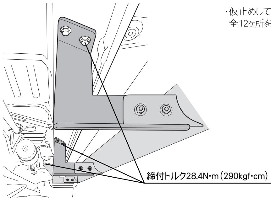
・仮止めしていた車体とブラケットを固定するボルト全12ヶ所を規定の締付トルクにて増し締めします。
