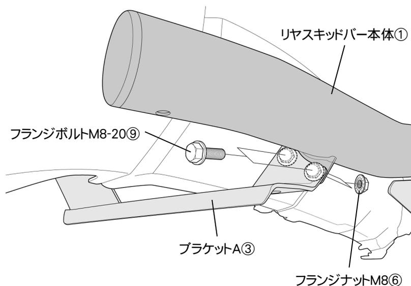
・リヤスキッドバー本体①の両側にある固定部が車体に取り付けたブラケットA③の内側になるように配置します。
