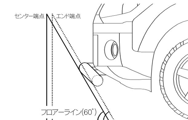
スキッドプレート部及びステーブラケット部は一般規定3.1.で定めている除外範囲(フロアラインより下方の部分)に該当するため外部突起規制の適応に当たりません。
