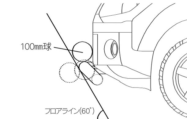
当製品については細目告示 別添20「外装の技術基準」の一般規定3.1.で定めている「100mm球が接触する箇所は測定対象」に基づき測定をしています。
