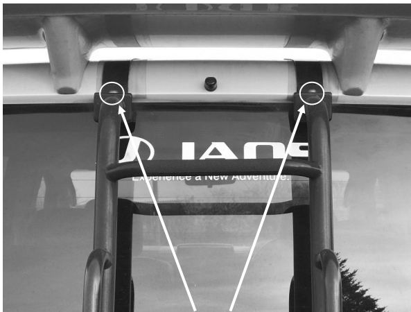
穴位置を合せ、ブラケットA②が垂直になる様配置し、ボディ側に保護シート④を、ブラケットA②の方へ保護パッド⑤を貼り付ける。
