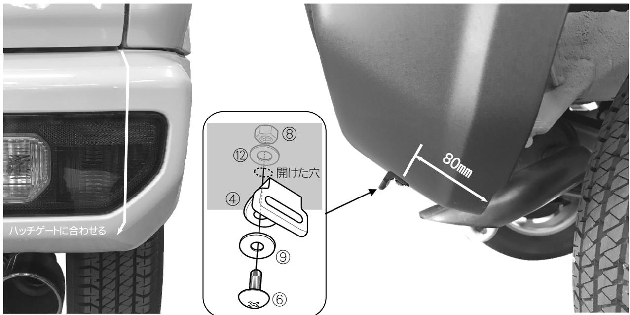
・横位置はリアのハッチゲートのラインに合わせ、奥行きはバンパーの端点から図った距離に合わせて印を付け、7.0mmのドリルで穴を開けます。
