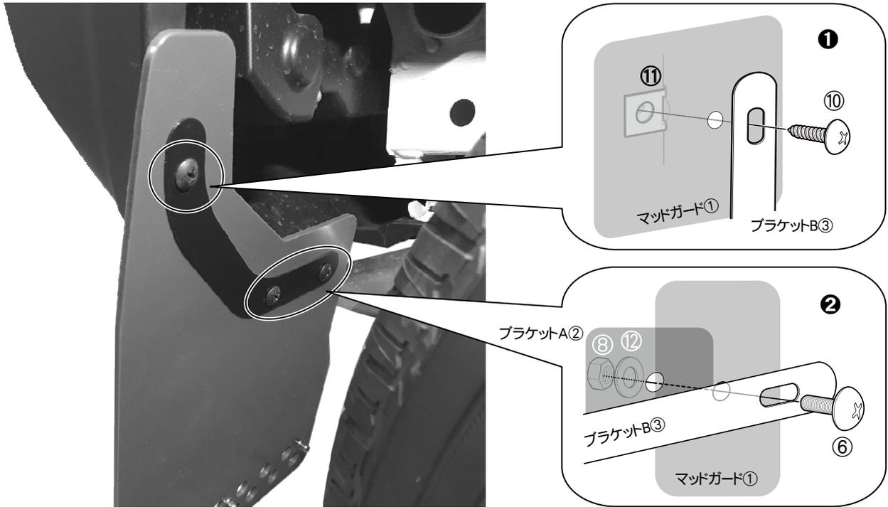
❶「2. スピードナットを取り付けます。」で差し込んだスピードナット⑪を差し込んだ箇所にマッドガード①の穴を合せあてがい、マッドガード側からブラケットB③、タッピングM5-20⑩で留め、仮組みします。
