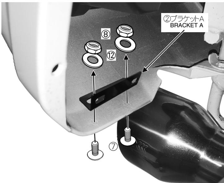
・穴を開けた個所にブラケットA②を内側からあてがい、トラスボルトM6-12⑦とナットM6⑧、ワッシャーM6(小)⑫で仮組します。
