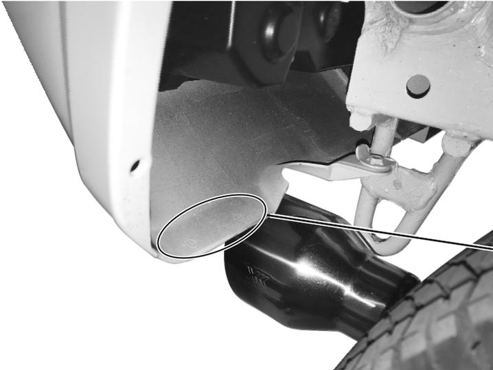
・バンパー裏にケガキ線がある(片側2点)ので下記寸法を表側へ写し、表側より木エドリル(7.0mm)にて穴を開けます。
