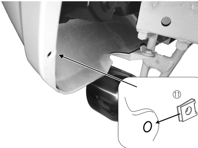
・バンパーの爪の部分にある穴にスピードナット⑪を差し込み、穴位置を合せます。
