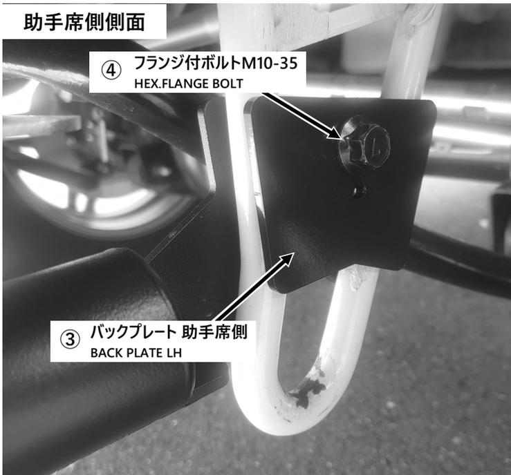
・運転席側同様、牽引フック内側に本体①のステーの凸部がはめ込まれている事を確認し、逆側からバックプレート助手席側③を合わせフランジ付ボルト④を差し込みます。
