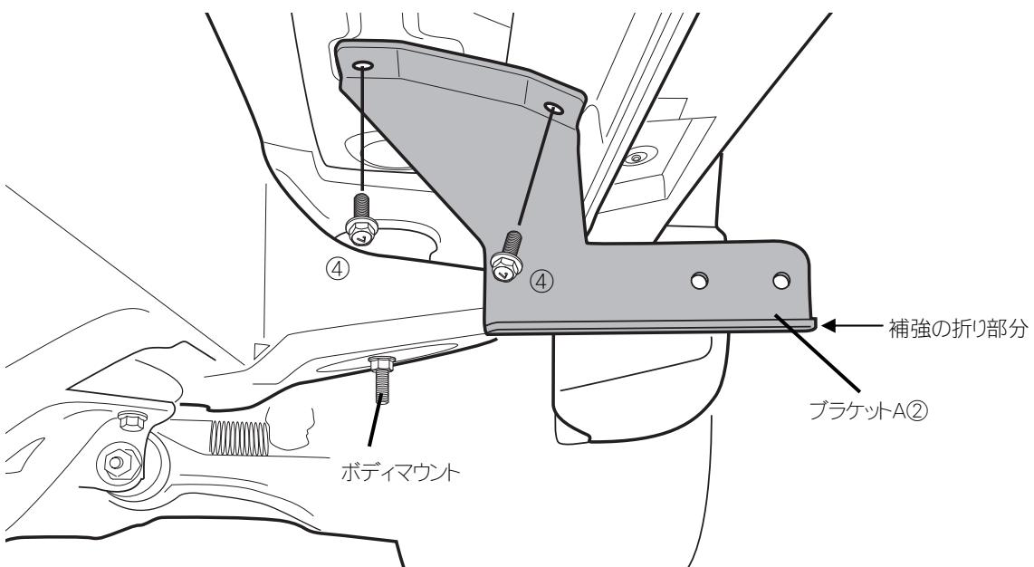
・フロントタイヤ後部の車底部（ボディマウント後部）にあるサービスホール2ヶ所を利用して、ブラケットA②をフランジ付ボルト④にて仮止めします。
