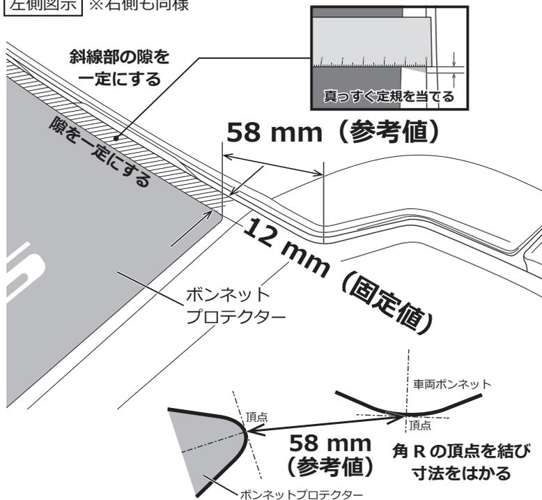
□図を参照し寸法をはかり、ボンネットにボンネットプロテクターを配置し、前後左右のバランスを整えます。
