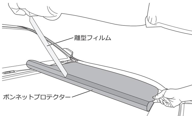
□中央部の細い離型フィルムをすべてはがし、固定した位置がずれないようにボンネットに貼り付けます。
