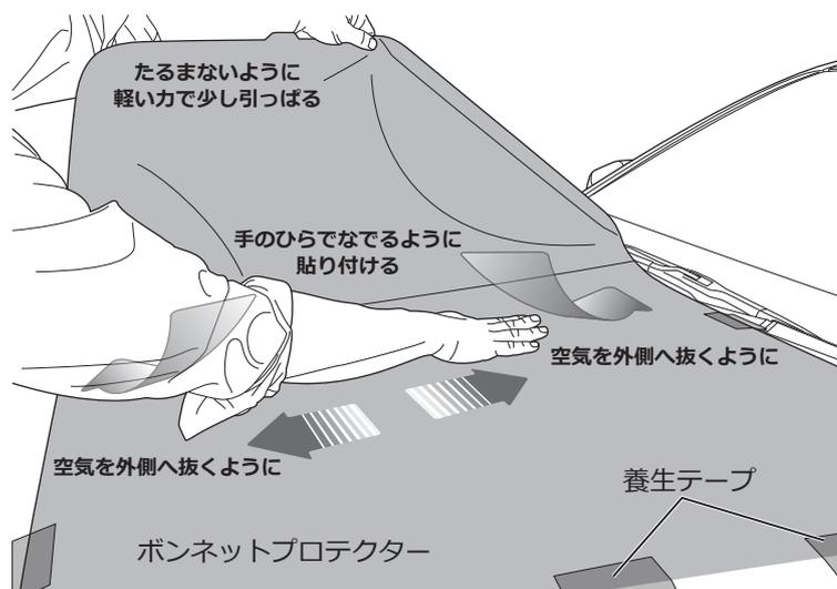
□貼る方向の端部を軽い力で少し引っばりたるまない状態にしなが、接着面の上から手のひらでなでるように貼り付けます。
